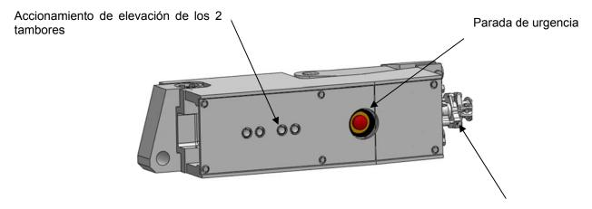
Prensa cable eléctrico alimentación rozadora
