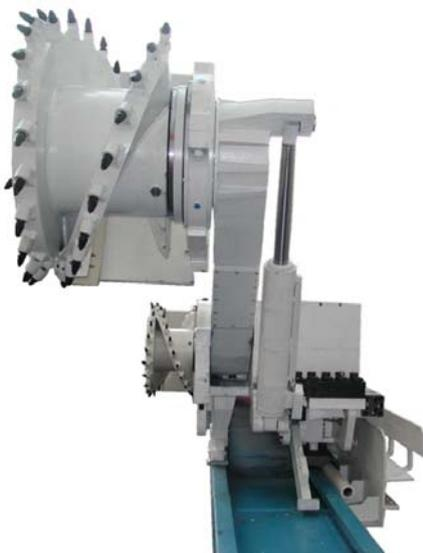
El chasis (1) portador de todos los grupos constituyentes de la rozadora, es una ménsula apoyada sobre el panzer a través de dos patines-guía, por el lado del hundimiento y dos patines de apoyo por el lado del paramento. La unión de los dos patines guía al chasis se realiza mediante dos cilindros hidráulicos de doble efecto, de manera que toda la máquina se puede volcar hacia el paramento, a fin de poder seguir la capa en dirección.
